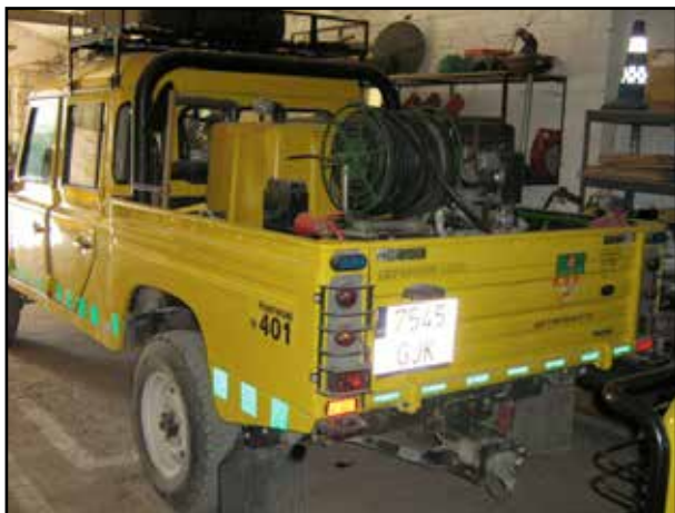
Imatge 18: Vehicle pick-up amb kit d'extinció d'incendis . Font: FPG.
