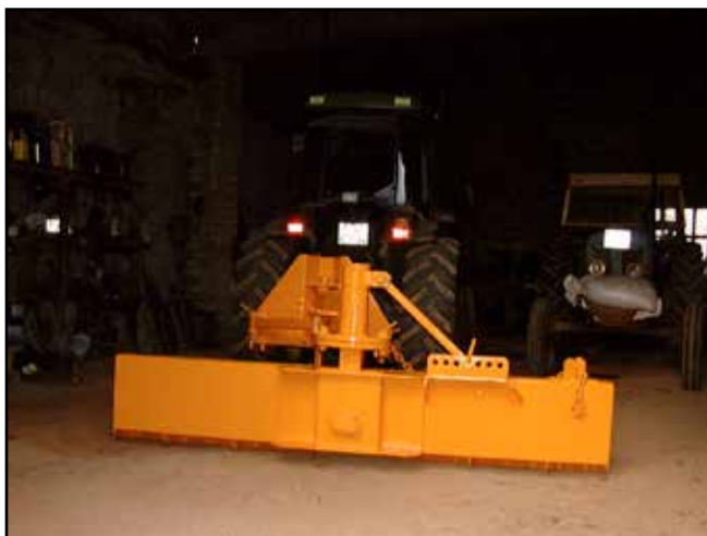
Imatge 28: Pala anivelladora. Font: DGF.
