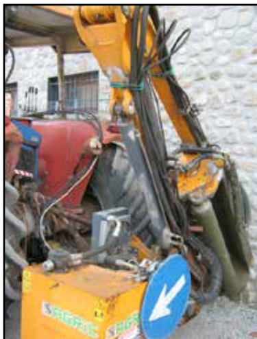
Imatge 26: Braç desbrossador enganxat al tractor. Font: FPG.
